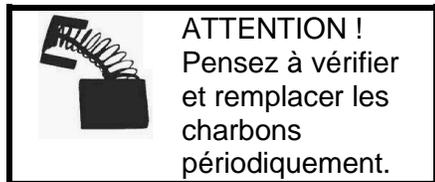
Vérifiez périodiquement l'état des balais. Ils doivent être remplacés lorsque la longueur des charbons mesure environ 5mm. Les balais doivent systématiquement être remplacés par paire. Gardez en permanence les balais propres et libres de pouvoir bouger dans le porte - balais.
